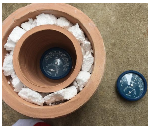
圖 4 學生運用不同的物料，以測試及改良無碳雪櫃的成效。
