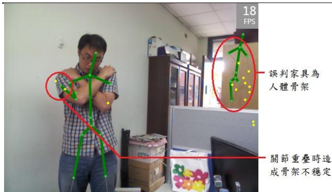
圖一、Kinect 骨架誤判與骨架不穩定
