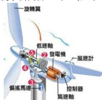
圖 3. 風力發電機零件名稱
