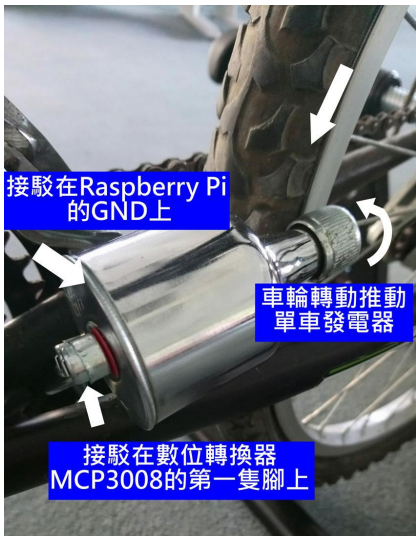
圖九 單車後輪的生電裝置
